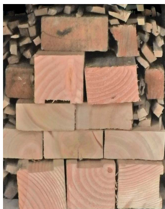
Рис. 9.1 Укладка дров в топке.
